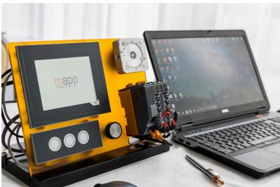
Mit dem ETA System stehen realitätsnahe Aufbauten für Ausbildung, Lehre und Labor zur Verfügung. Zwei verschiedene mechanische Grundkonstruktionen stehen zur Auswahl. Das ETA light System ermöglicht eine hohe Mobilität, ist platzsparend und eignet sich gut fürs Labor. Das ETA Standard System bietet eine robuste mechanische Konstruktion und beinhaltet vollständig verdrahtete Sensoren und Aktoren.
