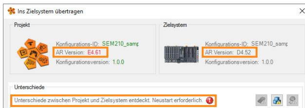
Abbildung 17: Darstellung von Versionsunterschieden im Transfer-Dialog; Neustart erforderlich
